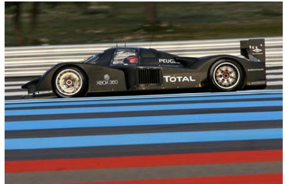
La vettura, come logico aspettarsi abbastanza differente dalla show car mostrata in tutti i saloni internazionali nel 2006, è dotata del 12 cilindri diesel a V da 100 gradi, di 5500 cc e interamente in alluminio, montato in posizione posteriore centrale e, novità rispetto a tutte le vetture finora schierate sulla Sarthe, è un prototipo chiuso, in ossequio al regolamento in vigore a Le Mans dal 2010.
